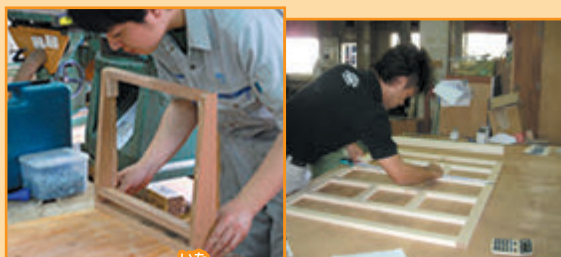
切った板を組み合わせます
