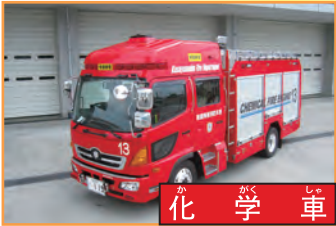
化学車 泡を出して油の火災に活躍します。
