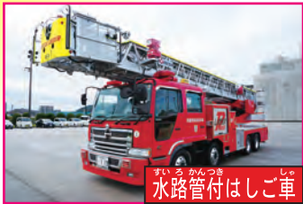
水路管付はしご車 最新式のはしご車で、高さ40mまで伸び、リモコン操作で大量の水を自由に放水することができます。
