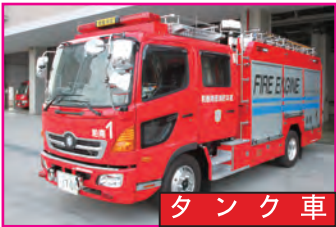
タンク車 水を2000ℓ積んで初期の消火に威力を発揮します。
