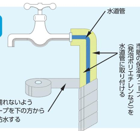
保温材が濡れないようビニールテープを下の方から巻き上げて防水する
