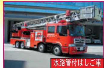
最新式のはしご車で、高さ40mまで伸び、リモコン操作で大量の水を自由に放水することができます。
